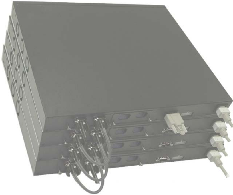
图 1-3. 连接堆叠交换机
